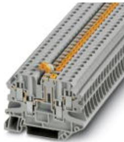
Messer-Trennklemme, Anschlussart: Schraubanschluss, Querschnitt: 0,14 mm<sup>2</sup> - 6 mm<sup>2</sup>, AWG: 26 - 10, Breite: 6,2 mm, Farbe: grau, Montageart: NS 35/7,5, NS 35/15
