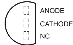
LM285-2.5, LM385-2.5, LM385B-2.5 . . . LP PACKAGE (TOP VIEW)
