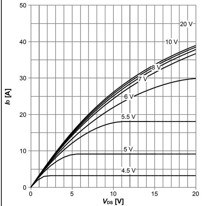
$I_D=f(V_{DS})$ ;  $T_j=125\text{ °C}$ ; parameter:  $V_{GS}$
