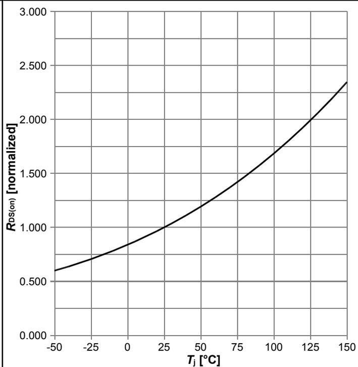
$R_{DS(on)}=f(T_j)$ ;  $I_D=5.6\text{ A}$ ;  $V_{GS}=10\text{ V}$
