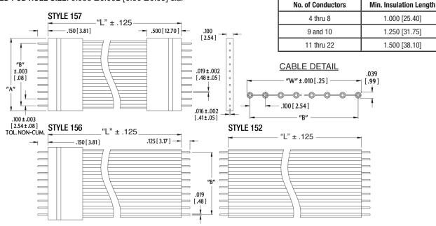
"A" =  $(NO. OF CONDUCTORS \times 0.100 [2.54]) + 0.040 [1.02]$
