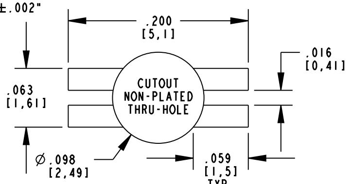
**RECOMMENDED SOLDER PAD LAYOUT****RoHS COMPLIANT 597-7783-60XF**
