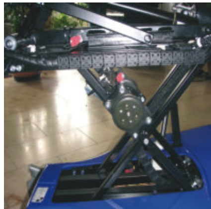
Serie E1.17.021.028 an einem E-Rollstuhl - Leitungsführung an Scherenhubvorrichtung zur Höhenverstellung des Patienten
