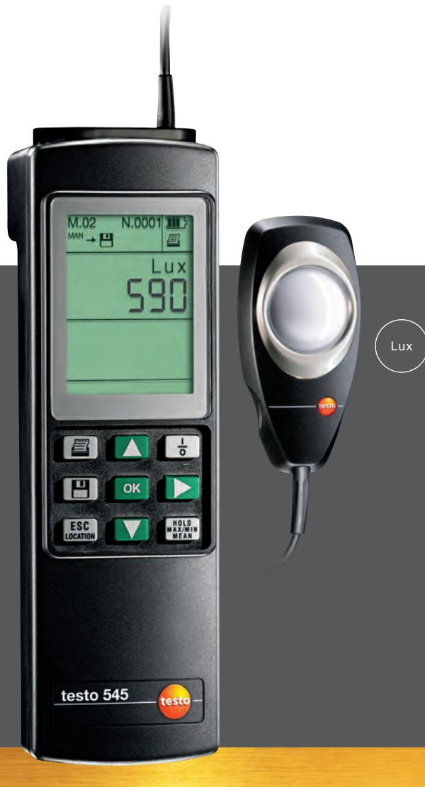
Damit Licht auch gutes Licht ist, muss die Beleuchtungsstärke an Arbeitsstätten, in Krankenhäusern, Büros oder Schulen bestimmten Mindestwerten genügen. testo 545 eignet sich ideal zur Überprüfung und Überwachung der Beleuchtungsstärke. Der Nutzer kann über die mitgelieferte Software bis zu 99 unterschiedliche Messorte hinterlegen und einzeln abgespeicherte Lichtstärkewerte zu einer Kurve verbinden. Dieses „Lichtprofil“ gibt Aufschluss über die Gleichmäßigkeit der Beleuchtung.
