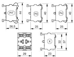
P3 = Steckanschluss 6.3 x 0.8 mm
