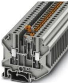
Messer-Trennklemme, Anschlussart: Schraubanschluss mit Federunterstützung, Querschnitt: 0,2 mm<sup>2</sup> - 6 mm<sup>2</sup>, AWG: 24 - 10, Nennstrom: 20 A, Nennspannung: 500 V, Länge: 63,4 mm, Breite: 6,2 mm, Farbe: grau, Montage: NS 35/7,5, NS 35/15, NS 32
