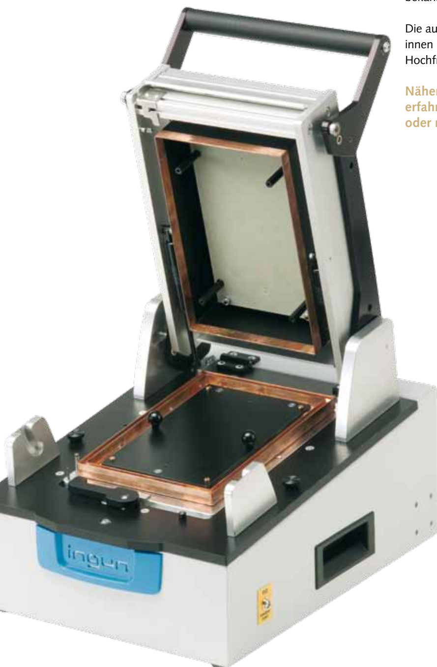
Hochfrequenz-Prüfadapter auf Basis MA 2111 mit ATS 2111/HF
