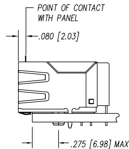
1. THE SUGGESTED PANEL OPENING IS INTENDED TO GIVE THE USER THE ABILITY TO HAVE REASONABLE JACK / PANEL CLEARANCES YET MAINTAIN RELIABLE GROUNDING CAPABILITY.
