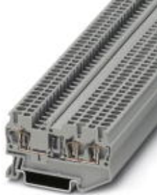
Bauelementreihenklemme, Anschlussart: Zugfederanschluss, Querschnitt: 0,08 mm 2 - 4 mm 2 , AWG: 28 - 12, Breite: 5,2 mm, Farbe: rot, Montageart: NS 35/7,5, NS 35/15
