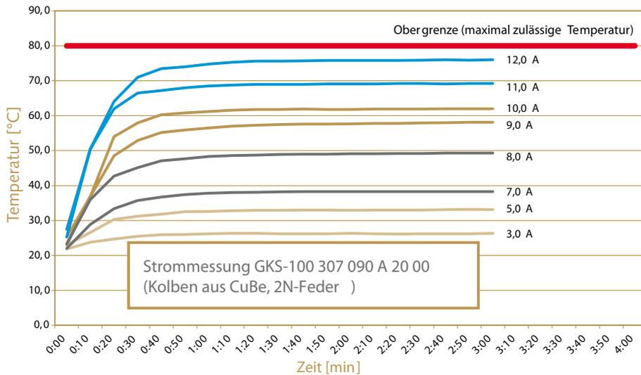
Das Diagramm zeigt die Auswertung für einen Kontaktstift der Baureihe GKS-100 mit CuBe-Kolben und 2,0 N-Feder.
