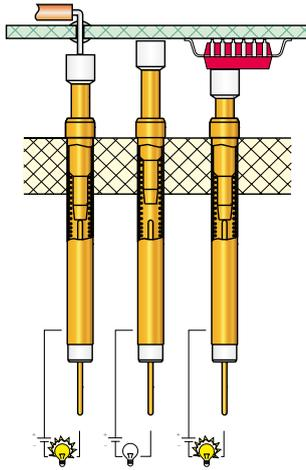
Zur Überprüfung der Anwesenheit von Bauelementen werden hauptsächlich Schaltkontaktstifte mit Kunststoffkappen eingesetzt. Nebenstehendes Beispiel erklärt die Funktionsweise der Prüfung: Ist das Bauteil anwesend, wird der Kolben eingedrückt und der Kontakt geschlossen, ist das abzufragende Element nicht vorhanden, fährt der Kolben ins Leere, der Schaltkontakt bleibt geöffnet.
