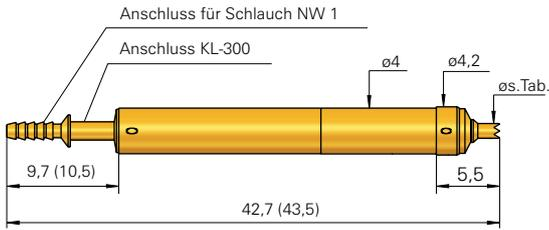
PKS-420 Typ 1: mit Anschluss für Schlauch NW 1
