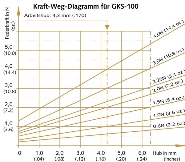
Abhängig davon, ob Prüfads oder Bauteilbeinchen kontaktiert werden, entstehen während der Kontaktierung unterschiedliche Hübe. In kritischen Fällen empfiehlt es sich, die Einbauhöhen entsprechend anzugleichen. Dies ist in fast allen Baureihen entweder durch Anpassung des E-Maßes (Kragenhöhe) an Kontaktstift oder Kontaktsteckhülse oder mit verlängerten Kolben (L-Versionen in den Baureihen GKS-050, 075 und 100) möglich.
