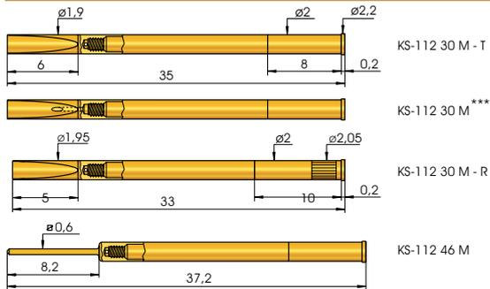
\*\*\*\* axial verlaufende Durchgangsbohrung für Leckageprüfung.
