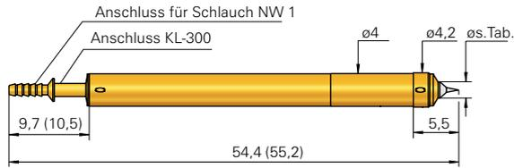
PKS-399 Typ 1: mit Anschluss für Schlauch NW1
