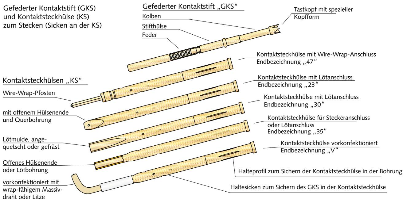
**Gefederte Kontaktstifte (GKS)** bestehen in der Regel aus drei Einzelteilen. Die Einzelteile müssen mit der Präzision gefertigt sein, wie sie von der Mikroelektronik verlangt wird.
