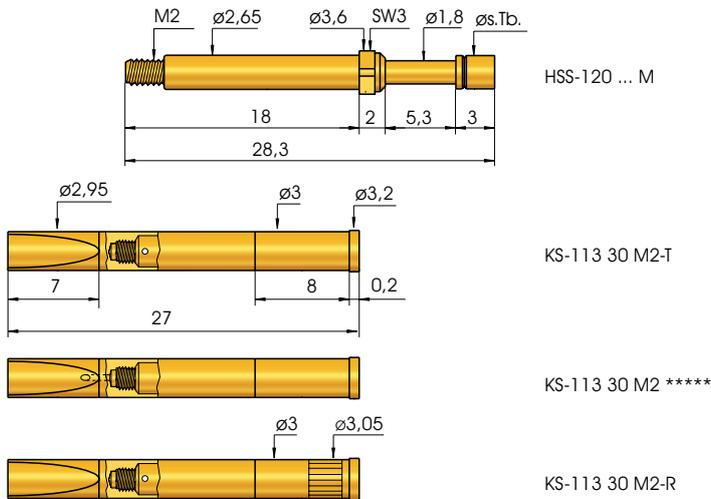
\*\*\*\*\* axial verlaufende Durchgangsbohrung für Leckageprüfung.
