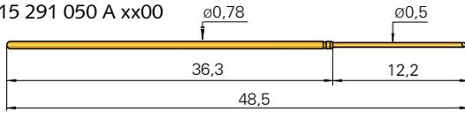
Maximaler Hub: 10,0 mm    Federkraft bei Arb. hub: 1,5 N
