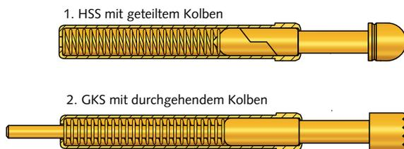
Alternativ zu den klassischen Hochstromstiften können zur Übertragung hoher Ströme auch Kontaktstifte mit durchgehendem Kolben eingesetzt werden. Dabei wird das Messsignal mit hochflexibler Litze (Gefahr von Kabelbruch durch die dauernde Bewegung) direkt am Kolbenende abgenommen. Bedingt durch den direkten Signalverlauf zeichnet sich diese Bauweise außerdem durch sehr stabile und gleichbleibend niedrige Eigenwiderstände aus.
