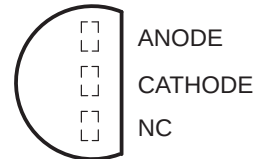
LM285-2.5, LM385-2.5, LM385B-2.5 . . . LP PACKAGE (TOP VIEW)
