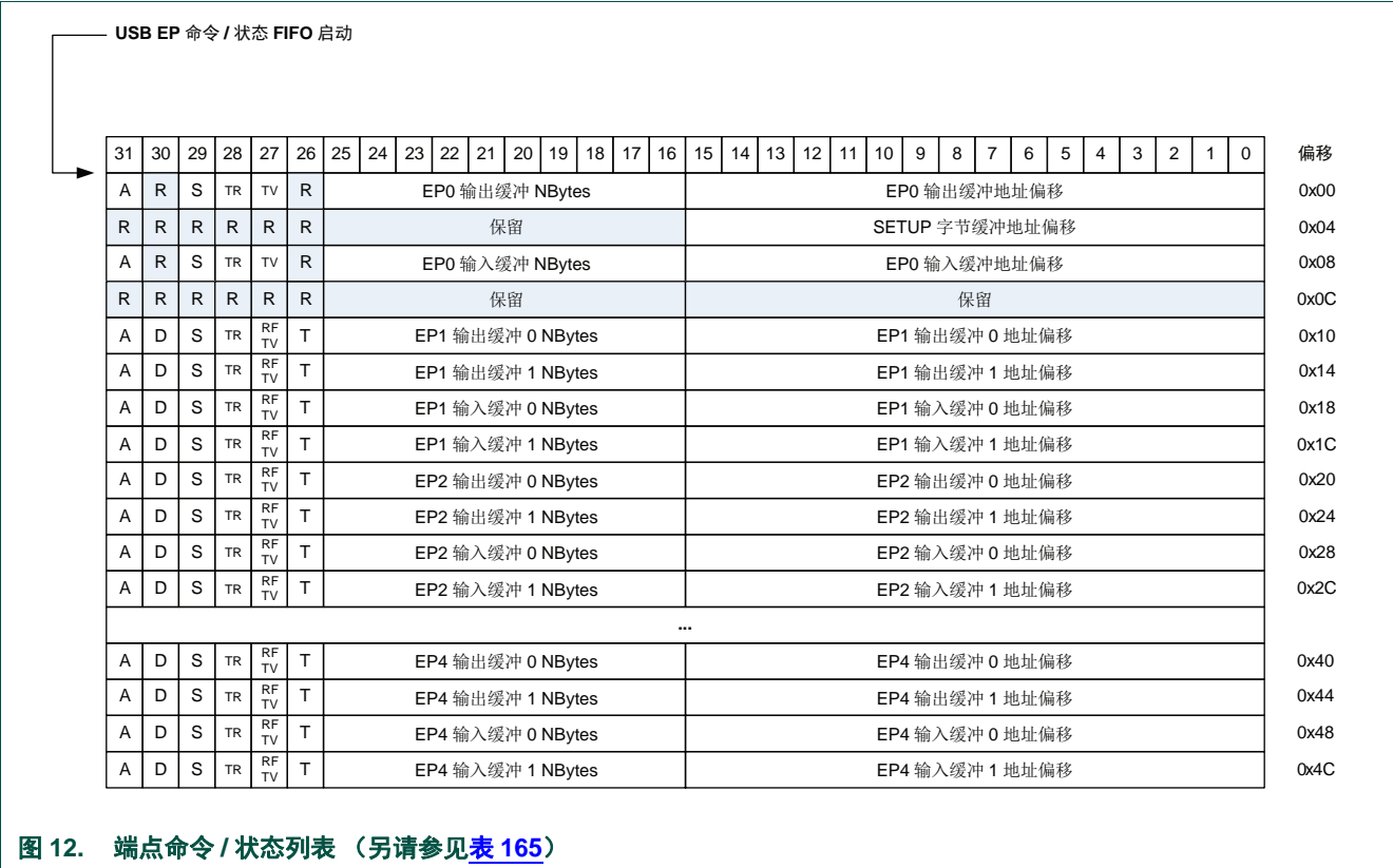
图 12 概述端点列表在存储器中的组织方式。USB EP 命令 / 状态列表起始寄存器指向存储器中包含所有端点信息的列表的起始点。端点的顺序固定为下图所示。
