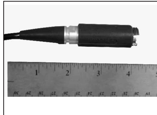
PRO BEAM Mini Plug Connector
