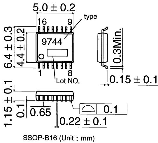
SSOP-B16 (Unit : mm)
