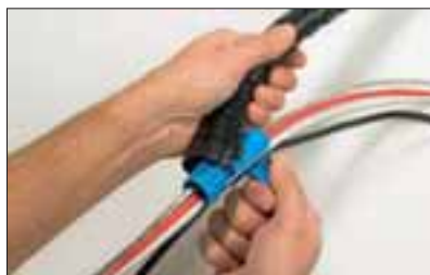
Trekk deretter ganske enkelt monteringsverktøyet gjennom Helawrap.
