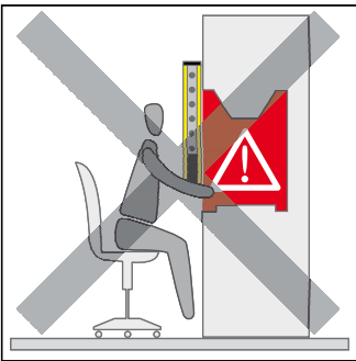
FIG. 12-16: ANORDNUNG DER SICHERHEITS-LICHTVORHÄNGE
