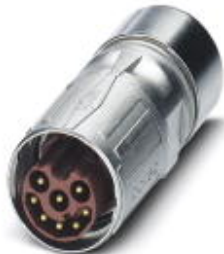
Kabelový zástrčkový spoj, přímý, Zajištění SPEEDCON, M17, Počet pólů: 17, Druh kontaktu: Kolík, Lisovaný spoj, stíněná: ano, Průměr kabelu: 9 mm...11 mm
