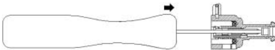
Figure 11 : Extraction d'un bouchon
