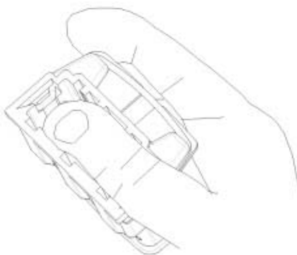
Figure 8 : Activation manuelle du verrou
