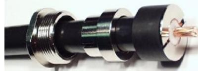
Mit einem Messer die Kupferfolie und das Dielektrikum entfernen. Der Innenleiter muss absolut rund bleiben, die scharfen Kanten entgraten.
