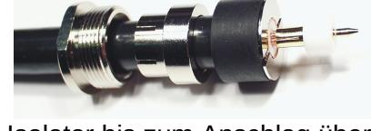
Teflon-Isolator bis zum Anschlag über den Innenstift schieben. Anschließend Innenstift vorsichtig auf den Innenleiter aufstecken. Tipp: Der Innenleiter kann vor dem Aufstecken des Innenstiftes mit einem hauchdünnen Vaseline-Film versehen werden. Das verbessert die Intermodulationsdämpfung und beugt Korrosion vor.
