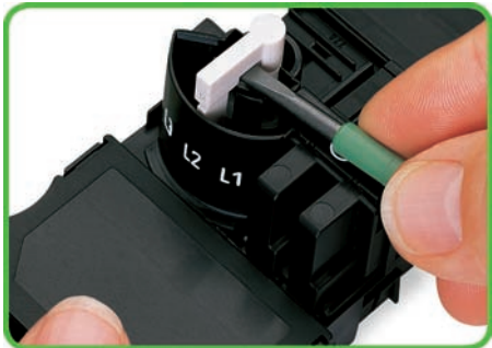
Den Schaltbrücker aus der Lieferposition (L2) mittels Schraubendreher heraushebeln und in die gewünschte Position drehen.
