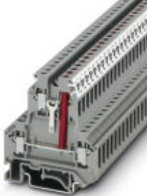
Bauelementreihenklemme, Anschlussart: Schraubanschluss, Querschnitt: 0,2 mm 2 - 4 mm 2 , AWG: 24 - 12, Breite: 6,2 mm, Farbe: grau, Montageart: NS 35/7,5, NS 35/15, NS 32
