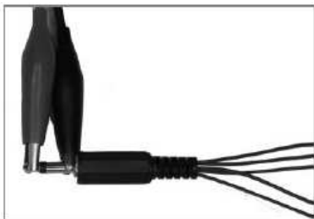
Slika 6.25: priključitev krokodiljih sponk na velik vtič vžigalnih svečk
