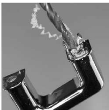
Slika 6.28: obdelava / vrtanje v zbiralnik izpušne cevi (42)
