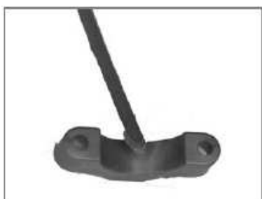
Slika 2.7: mazanje premičnih delov s silikonskim mazivom
