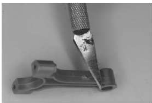
Slika 2.5: Odstranitev prečk / robov z nožem
