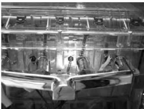
Slika 6.32: model motorja med vžigom v cilindru št. 3
