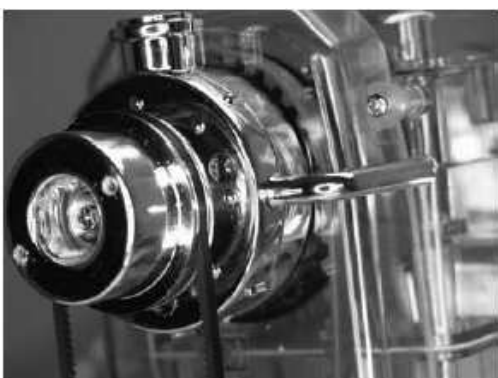
Slika 3.4: črpalka hladilne tekočine in pogon zobatega jermena pri modelu
