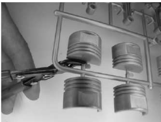
Slika 2.4. odstranitev delov z kleščami ščipalkami
