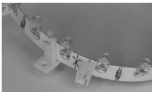
Slika 6.31: LED na tekočem traku, ki so lahko razrezani za različne namene osvetlitve; spodaj: detajl
