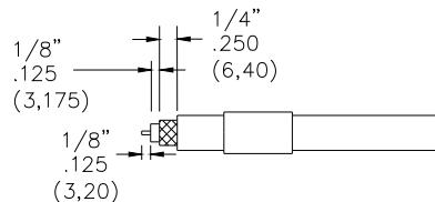
3. STRIP CABLE JACKET, BRAID, AND DIELECTRIC TO SPECIFICATION LENGTHS. (NOTE: FOIL AND BRAID CABLES SHOULD LEAVE FOIL TO END OF DIELECTRIC).
