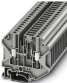
Trennklemme, Anschlussart: Schraubanschluss mit Federunterstützung, Querschnitt: 0,2 mm<sup>2</sup> - 6 mm<sup>2</sup>, AWG: 24 - 10, Nennstrom: 20 A, Nennspannung: 500 V, Länge: 63,4 mm, Breite: 6,2 mm, Farbe: grau, Montage: NS 35/7,5, NS 35/15, NS 32
