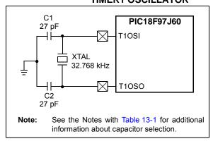
TABLE 13-1: CAPACITOR SELECTION FOR THE TIMER1 OSCILLATOR<sup>(2,3,4)</sup>
