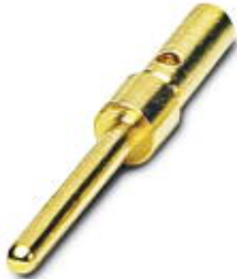
Crimpkontakt, für D-SUB-Kontakteinsätze mit Standard-Kontaktlichte, Stift, Anschlussquerschnitt AWG 28 ... 24, gedreht, vergoldet
