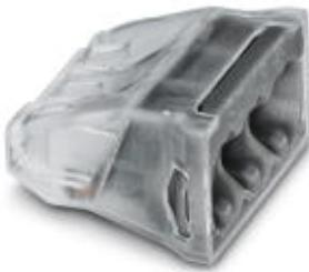
3-polige Dosenklemme mit Federkraftanschluss, zur werkzeuglosen Verdrahtung durch Push-in-Anschlussstechnik, für ein- und mehrdrähtige Leiter mit einem Querschnitt von 0,5 bis 2,5 mm<sup>2</sup>, Isoliergehäuse transparent.
