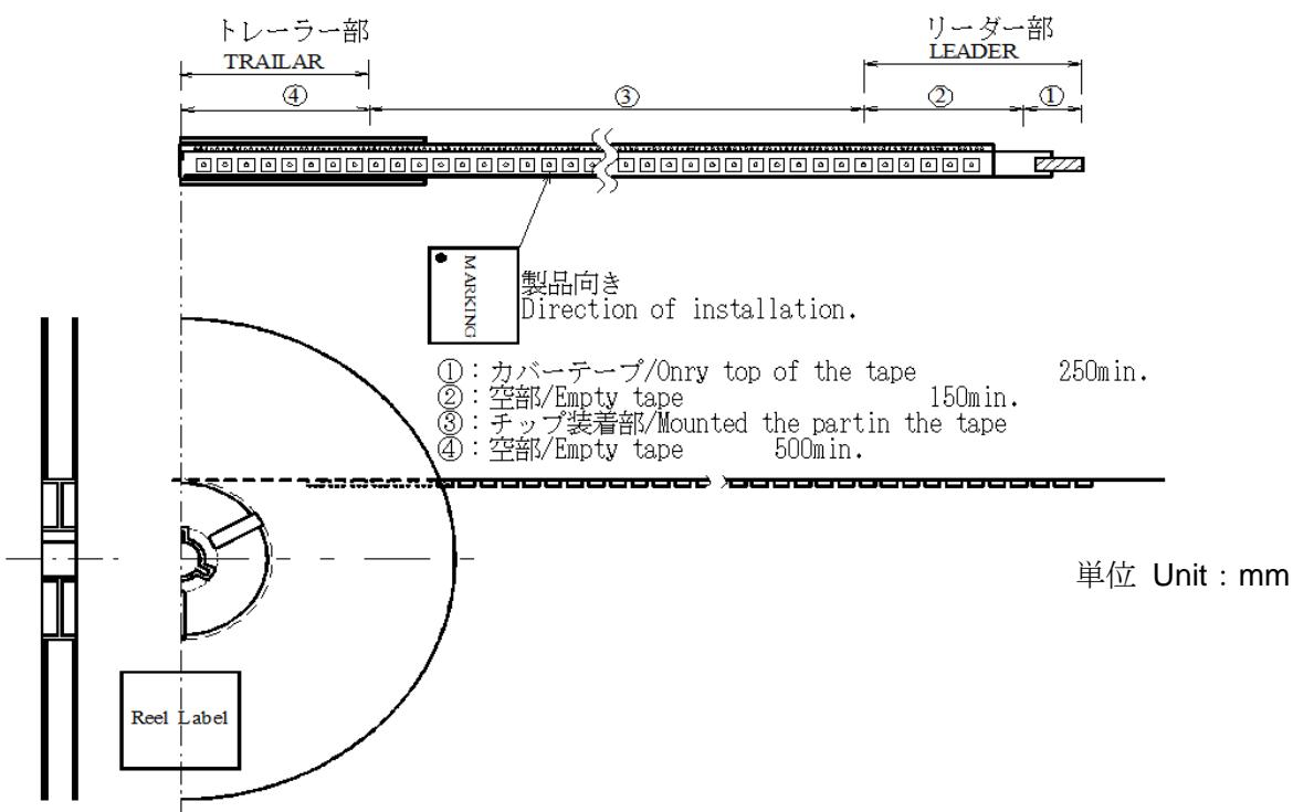
\*リーダー部の先端は粘着テープで留めることとします。引き出し方向は図の通りとします。
