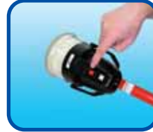
Per l'accensione premere l'interruttore rosso. Il LED si illumina con una luce verde. Un lampeggio lento indica un funzionamento normale e una condizione di STANDBY
