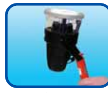
Mettre le système de verrouillage et placer sur le détecteur
