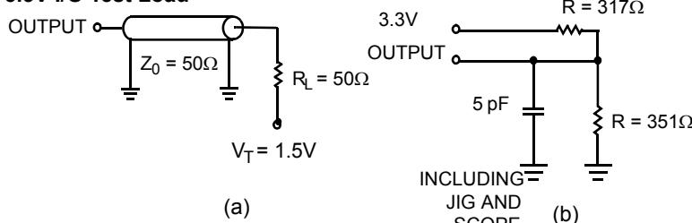
**2.5V I/O Test Load**
