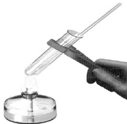
Ogrzewanie w probówce. Szklany pręt zapobiega pryskaniu.
