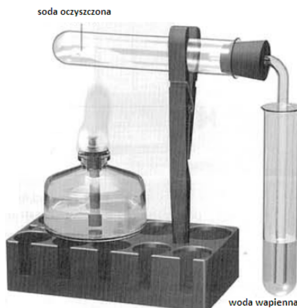
Rozpad sody oczyszczonej pod wpływem ciepła
