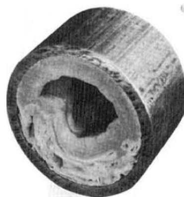
Rura przewodowa zwężona przez złoże wapienne (Zdjęcie: ELGA Berkefeld GmbH, Celle)
