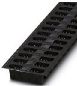
Grundgehäuse, Nennstrom: 8 A, Bemessungsspannung (III/2): 250 V, Polzahl: 6, Rastermaß: 3,5 mm, Farbe: schwarz, Kontaktobерfläche: Zinn, Montage: Gurtverpackte SMD/THT/THR - Bauelemente, Spannung und Strom sind abhängig von der eingesetzten Steckklemme.
