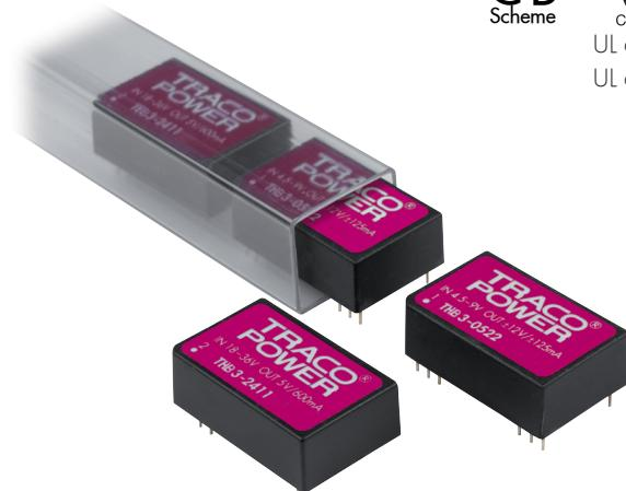
Die THB 3 Serie bietet eine neue sehr leistungsfähige Generation, geregelter DC/DC-Konverter in einem DIL-24 Kunststoffgehäuse. Die verstärkte E/A-Isolierung und der weite 2:1 Eingangsbereich machen sie zur optimalen Lösung für den Transport- und Industriebereich, sowie medizin- bzw. messtechnische Applikationen, also überall dort wo sehr hohe Isolationsspannungen, eine verstärkte Isolierung und besondere Sicherheitsstandards erforderlich sind.
