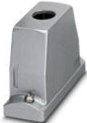
HEAVYCON ADVANCE Standard-Pulverbeschichtet, Tüllengehäuse B16, mit Schraubverriegelung, Höhe 100 mm, mit Gewinde 1x M40, geradem Kabelabgang
