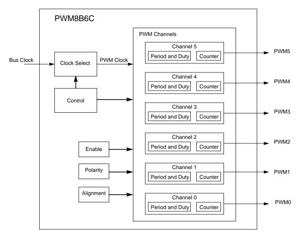
Figure 12-1. PWM8B6CV1 Block Diagram
