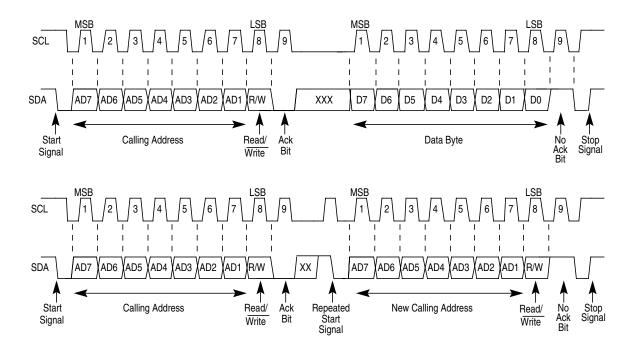
Figure 10-9. IIC-Bus Transmission Signals
