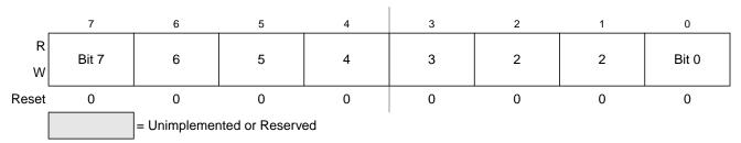
Figure 9-7. SPI Data Register (SPIDR)
