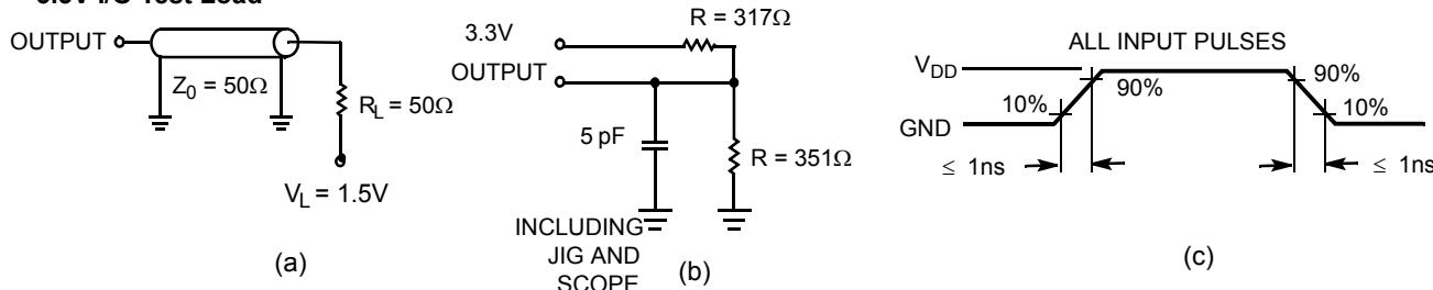
**2.5V I/O Test Load**
