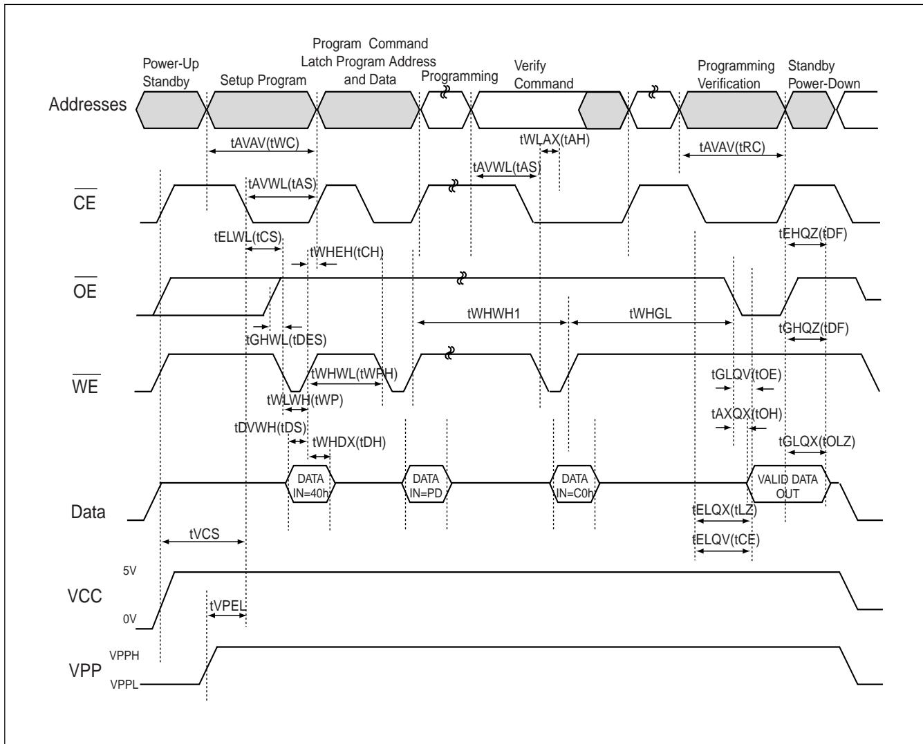
**AC WAVEFORMS FOR PROGRAMMING OPERATIONS**
