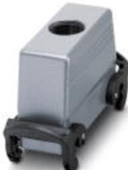
HEAVYCON Tüllengehäuse B24, mit Querbügel, Höhe 76 mm, mit Gewinde 1x M32, Leitungsabgang seitlich
