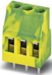
Leiterplattenklemme, Nennstrom: 24 A, Nennspannung: 400 V, Rastermaß: 5,08 mm, Polzahl: 3, Anschlussart: Schraubanschluss, Montage: Löten, Anschlussrichtung Leiter/Platine: 0 °, Farbe: grün-gelb, Anschlüsse intern gebrückt
