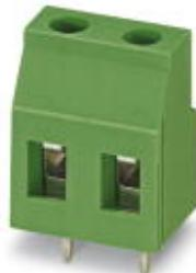
Leiterplattenklemme, Nennstrom: 24 A, Nennspannung: 630 V, Rastermaß: 7,5 mm, Polzahl: 6, Anschlussart: Schraubanschluss, Montage: Löten, Anschlussrichtung Leiter/Platine: 0 °, Farbe: grün
