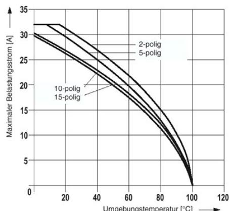
Deratingkurve für die Zugfederklemmen ST 4/1P.. und ST 4/2P.. mit allen Steckervarianten SP 4/.... Die Deratingkurven werden durch die Multiplikation der Werte der Basiskurven mit dem Faktor 0,8 bestimmt.
