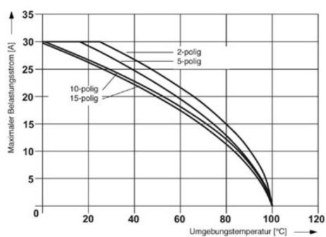
Deratingkurve für ST 4/ 1P und für alle Steckervarianten SP... .
