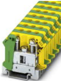
Installationsschutzleiterklemme, Schraubanschluss, Querschnitt: 0,75 mm 2 - 35 mm 2 , AWG: 18 - 2, Breite: 15 mm, Farbe: grün-gelb, Montageart: NS 35/7,5, NS 35/15
