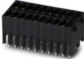
Grundgehäuse, Nennstrom: 8 A, Bemessungsspannung (III/2): 200 V, Polzahl: 6, Rastermaß: 3,5 mm, Farbe: schwarz, Kontaktobерfläche: Zinn, Montage: SMD/THT/THR, Artikel mit Rastnase. Die Pinlänge beträgt 2,6 mm. Anwenderinformationen und Designempfehlungen zur Through Hole Reflow Technologie finden Sie unter : <http://www.combicon.com>
