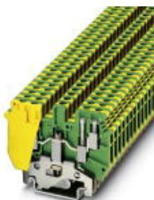
Schutzleiter-Reihenklemme, mit Doppelanschluss auf jeder Seite, Anschlussart: Schraubanschluss, Querschnitt: 0,2 mm<sup>2</sup> - 6 mm<sup>2</sup>, AWG: 24 - 10, Breite: 6,2 mm, Farbe: grün-gelb, Montageart: NS 35/7,5, NS 35/15, NS 32
