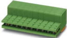
Direktsteckverbinder, Nennstrom: 10 A, Bemessungsspannung (III/2): 320 V, Polzahl: 4, Rastermaß: 5 mm, Anschlussart: Federkraftanschluss, Farbe: grün, Kontaktobерfläche: Zinn, Montage: Direktsteckverbinder
