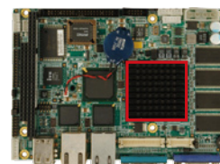
WAFER-LX3-800 : 0°C ~ 60°C operating temperature
