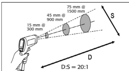
Je weiter man sich also vom Messpunkt entfernt, desto größer wird die Messfläche. Nutzen Sie, wenn dies möglich ist, die maximale Entfernung nur zu max. 75% aus. So ist sichergestellt, dass bei kleineren Messflächen keine Verfälschung durch dahinter liegende Gegenstände erfolgt:
